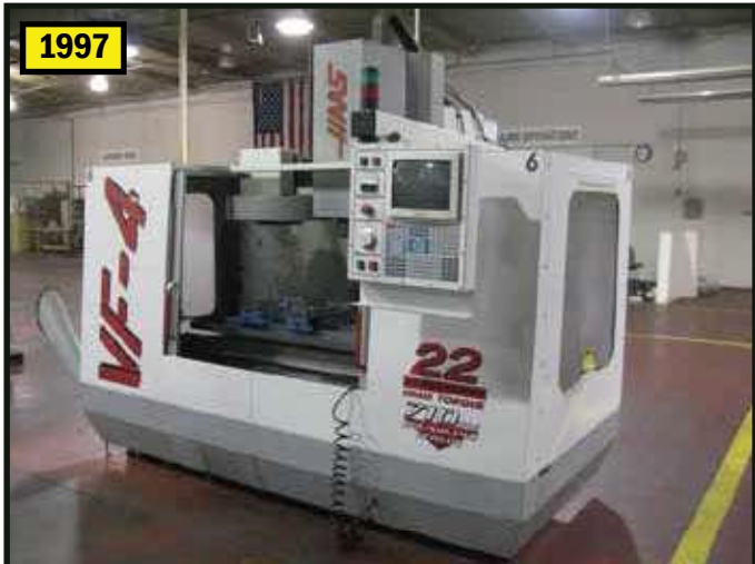
1997 HAAS VF-4 CNC VMC, 50 x 20 x 25 (XYZ) 122 HP
